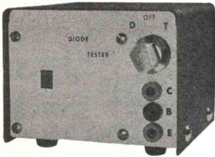
Fig. 6 - Al termine delle operazioni di costruzione, il dispositivo per la prova di diodi digitali può assumere l'aspetto qui illustrato.
