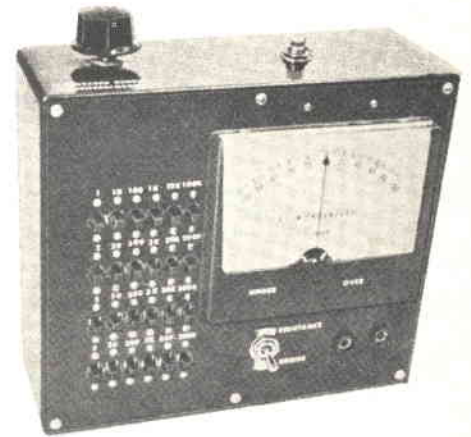
Fig. 15 - Fotografia dello strumento completo visto anteriormente: si noti il galvanometro a zero centrale.
